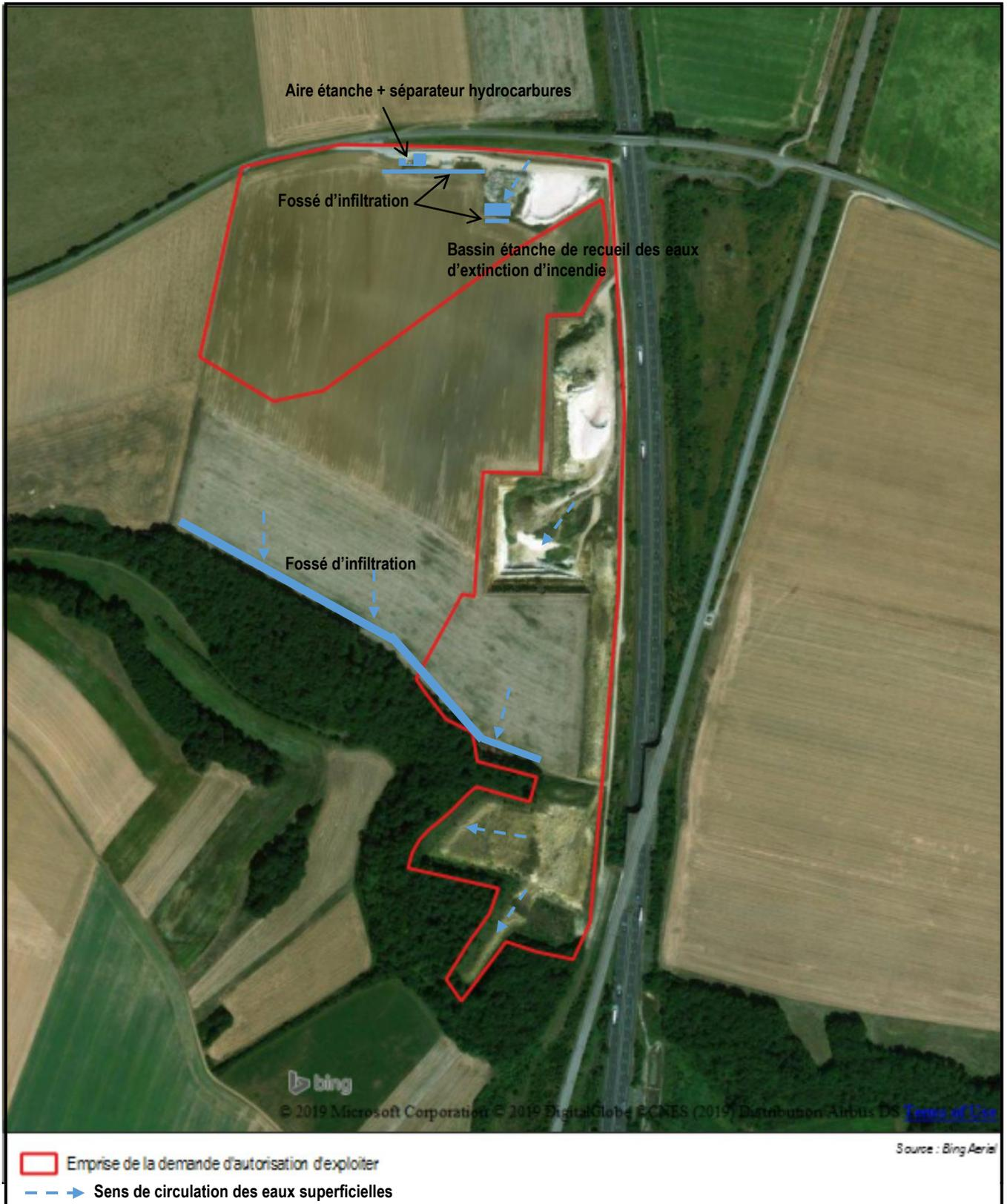
Figure 22 : plan de circulation des eaux sur la carrière des Terres Salées
